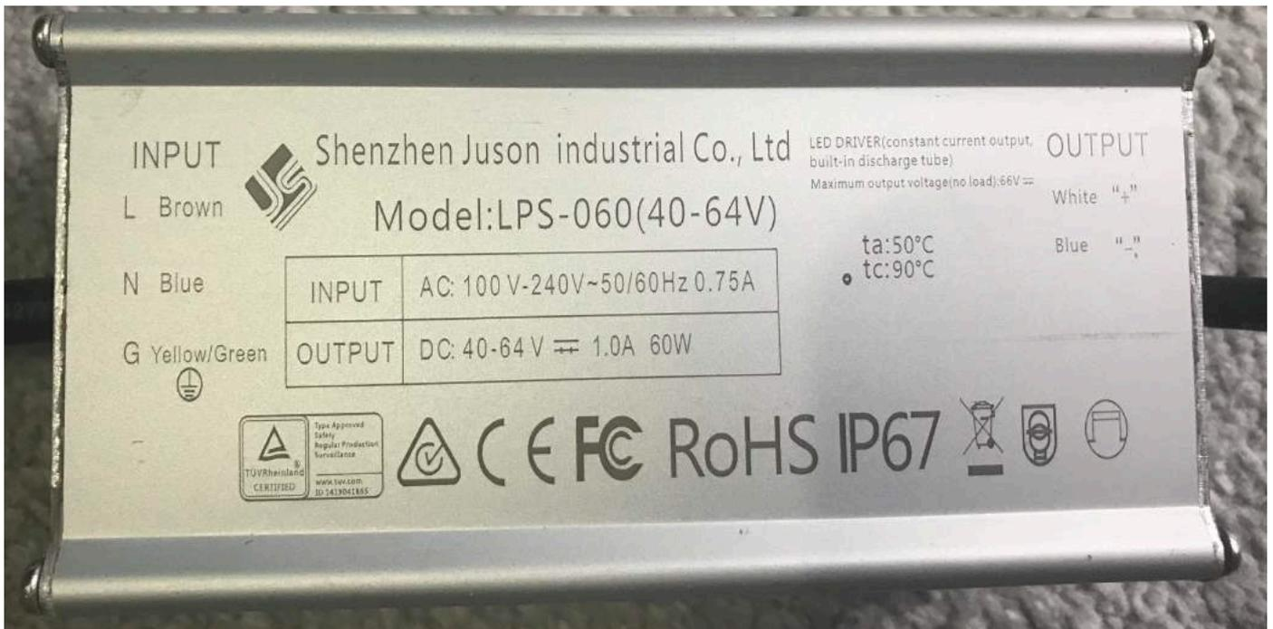
Nous allons simplement remplacer ce driver par un driver équivalent mais dimmable en PWM
